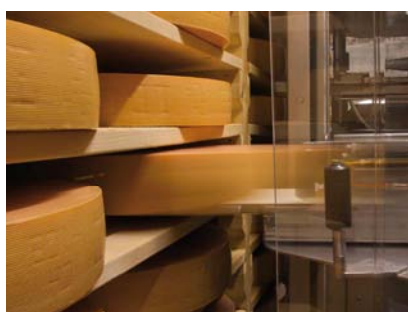
▶ Système de prise de meules par tapis
