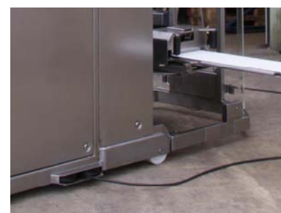
▶ Système d'enroulement du câble d'alimentation motorisé bidirectionnel
