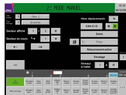
▶ Le terminal de commande tactile permet un réglage aisé de toutes les fonctionnalités
